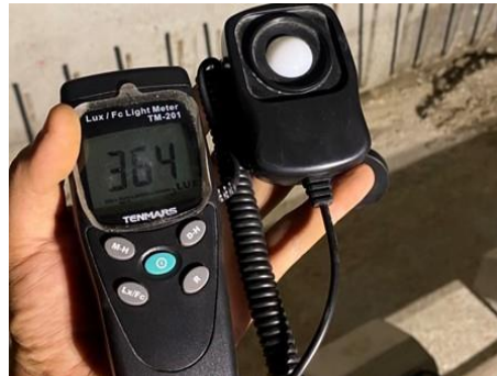
การตรวจสอบสภาวะแวดล้อมในสถานที่ทำงานภายในอุโมงค์
